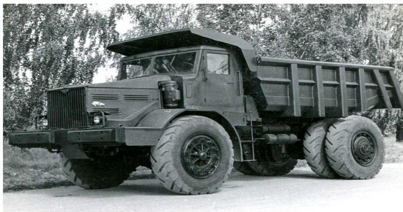
Рис. 4.6. МАЗ-525 с гидравлическим сцеплением.
