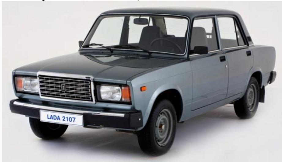
Рис. 6.5. ВАЗ-2107 с гидравлическим приводом сцепления. Годы пр-ва: 1982–1991 в СССР; 1991–2012 в России; 2003–2012 на Украине; 2006–2014 в Египте. Производитель: АвтоВАЗ
