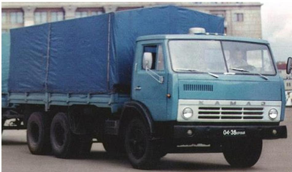
Рис. 6.6. КАМАЗ-5320 с гидравлическим приводом сцепления с пневмоусилителем. Годы пр-ва: 1976–2001. Производитель: КамАЗ (Камский
