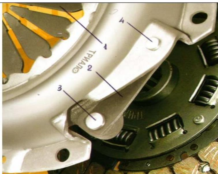
одним концом крепятся к кожуху сцепления, а другим – к нажимному диску (рис. 5.1).
