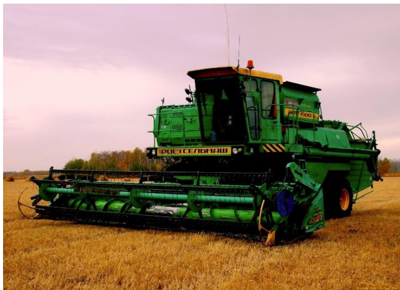
Рис. 6.2. Зерноуборочных комбайн «Дон-1500» (Россия, «Ростсельмаш», 1986–2006 гг.)
