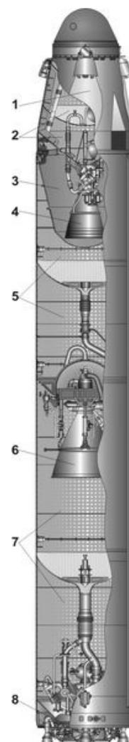
1. РГЧ; 2. топливные баки III ступени и РГЧ; 3. отсек боевых блоков; 4. двигатель III ступени; 5. топливные баки II ступени; 6. двигатель II ступени; 7. топливные баки I ступени; 8. двигатель I ступени.
