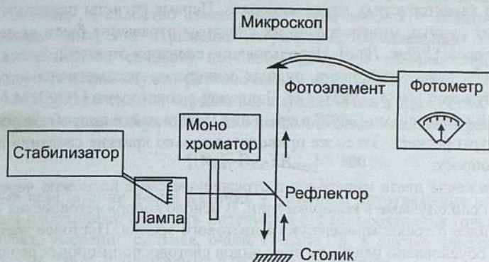
Рис. 4.2. Общая схема фотометрической установки.
