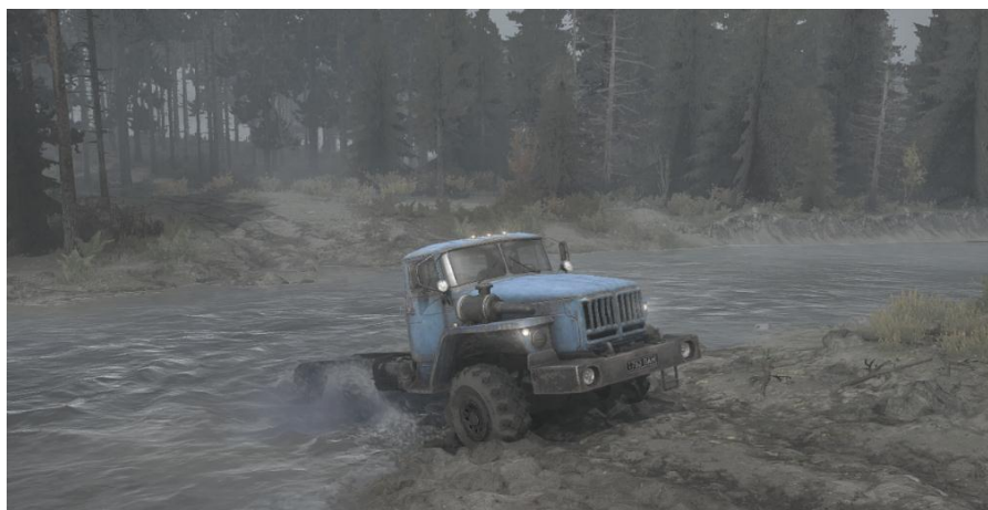
Рисунок 4. Преодоление брода без заблокированного межосевого дифференциала. (100% крутящего момента передается на заднюю тележку)
