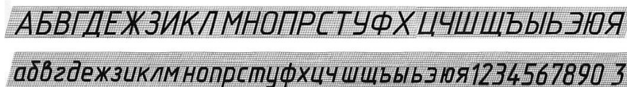
Рис. 1.19. Начертание букв, цифр и знаков по ГОСТ 2.304-81
