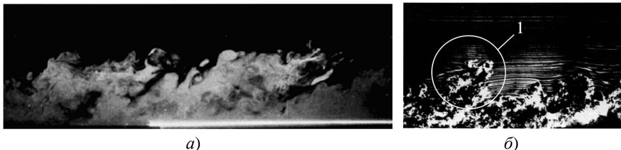
Рис. 14.6. Турбулентный пограничный слой: *a* – пограничный слой на пластине; *б* – внешняя область пограничного слоя; 1 – когерентная структура
